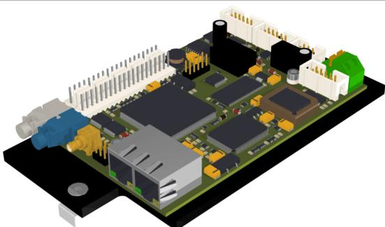
El **SMM 400 Bus-Maestro** es el interfaz entre el PC (vía ETHERNET) y el módulo del sistema de medida (a través de un ring bus RS 485).
